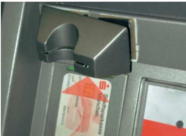
Falošné krytky mávajú podobný dizajn ako bankomaty, na ktorý sú použité, takže je ťažké odhaliť zmenu.
