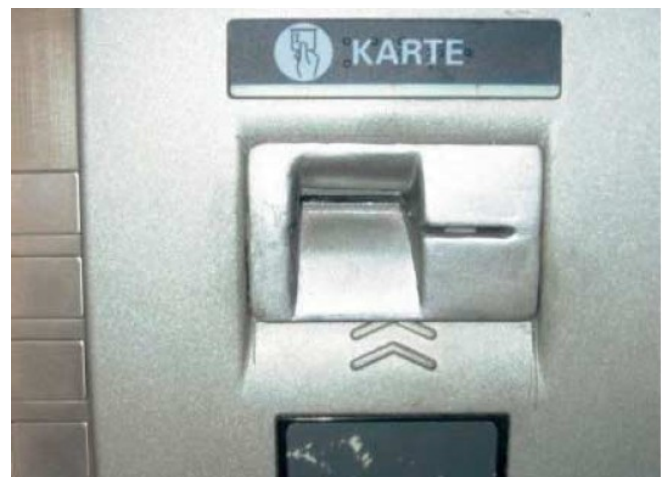
Falošné krytky mávajú podobný dizajn ako bankomaty, na ktorý sú použité, takže je ťažké odhaliť zmenu.
