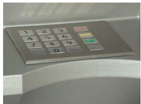
Všimli by ste si túto falošnú klávesnicu umiestnenú nad ňou?
