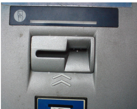
otvor pre kartu s falošnou krytkou (skimmerom)
